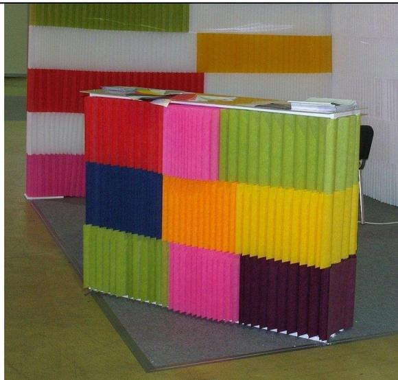
Honeycomb ®Modules Bar - это барная стойка или стол ресепшн из блоков, изготовленных из DropPaper® имеющих в сечении структуру пчелиных сот. Стандартные размеры: высота 1,1 м, длина 1,5 метров и ширина 0,4 м. Собирается выставочный стол, как конструктор, из блоков на металлическую основу. Сверху устанавливается покрытие из поликарбоната. В собранном состоянии занимает 0,1 м3
