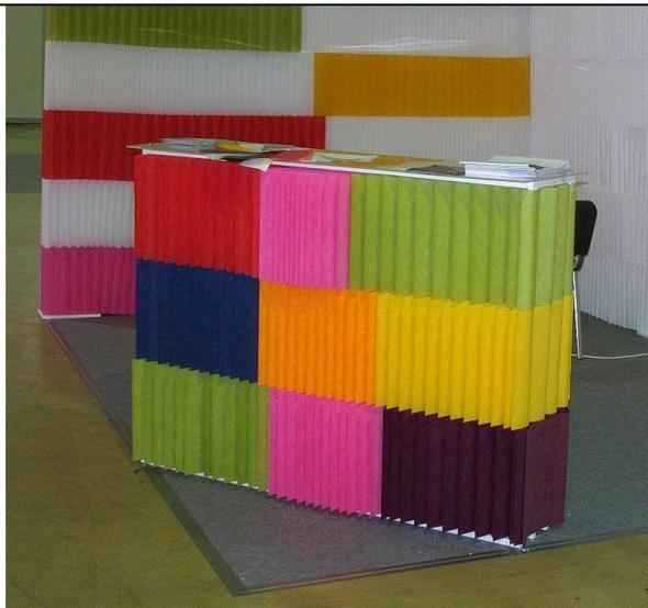
Honeycomb ®Modules Bar - это барная стойка или стол ресепшн из блоков, изготовленных из DtopPaper® имеющих в сечении структуру пчелиных сот. Стандартные размеры: высота 1,1 м, длина 1,5 метров и ширина 0,4 м. Собирается выставочный стол, как конструктор, из блоков на металлическую основу. Сверху устанавливается покрытие из поликарбоната. В собранном состоянии занимает 0,1 м3
